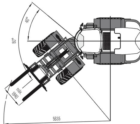
Carga útil, recorrido total de elevación: 5000 kg
